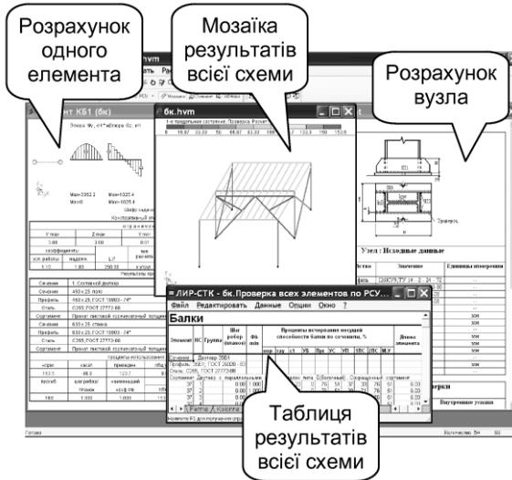
Рис. 1.4 Вигляд вікна підсистеми розрахунку металевих конструкцій СТК-САПР
