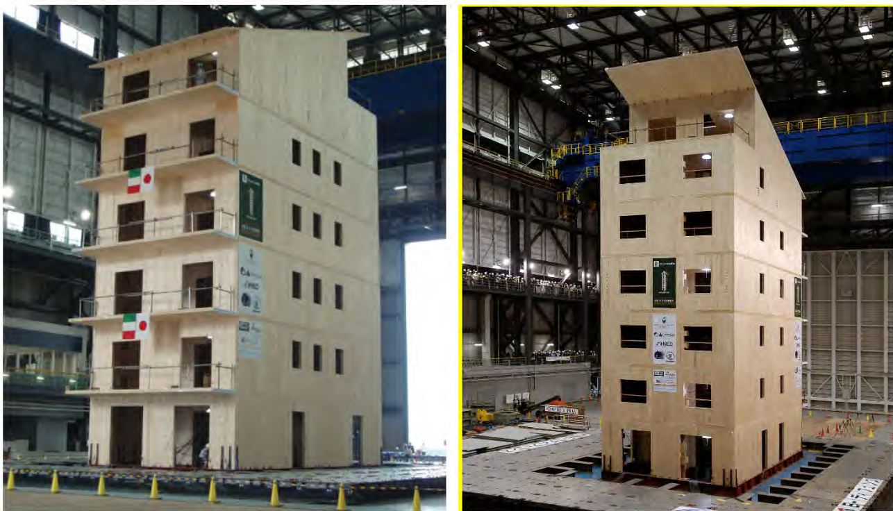
Рис. 1.5 Натурні випробування панельного будинку з поперечно-клеєної деревини на сейсмічні навантаження
