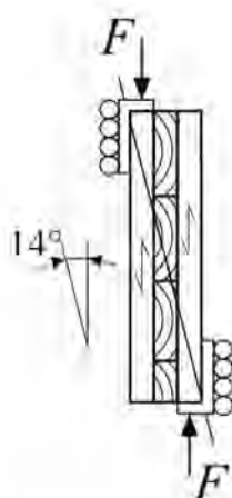
Рис. 2.14 Схема випробування панелей на сколювання
