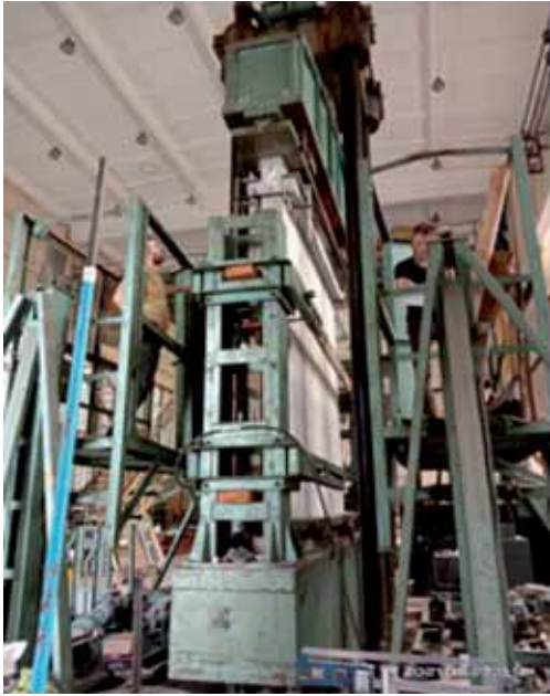
Рисунок 7 - Випробування окремих панелей на вертикальні (ліворуч), та на сполучення вертикальних та горизонтальних навантажень (праворуч)
