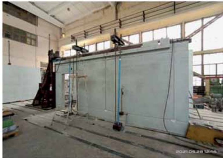
Рисунок 7 - Випробування окремих панелей на вертикальні (ліворуч), та на сполучення вертикальних та горизонтальних навантажень (праворуч)
